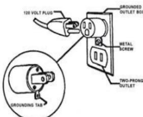
120 V makineler, bu şekilde üç iletkenli kabloların sonunda bulunan üç girişli prizlere sahiptir. Fiş üzerindeki topraklama pini, makineyi üç girişli prize bağlandığınızda topraklar.
