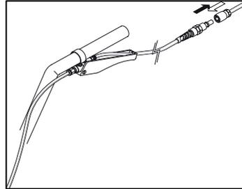
5. Aynı şekilde vakum hortumunu da makineye ve aksesuar sapına bağlamalısınız.
